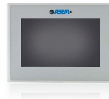
I panel ARM based IPC della famiglia RT25 sono i sistemi con i tagli di LCD più piccoli del portfolio ASEM e sono basati sul processore ARM Cortex A8 da 1GHz (i.MX535). La motherboard "all in one" include una porta Ethernet 100 Mbps, una porta USB 2.0 e un'interfaccia seriale
