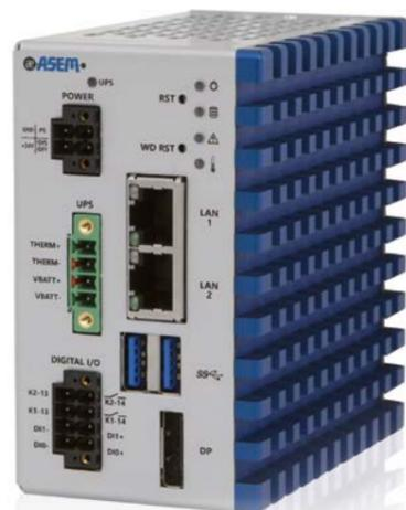
I sistemi fanless BM110 è un sistema compatto basato sui processori Intel® Atom™ x5-3930 1.3GHz (1.8GHz Burst) e x7-E3950 1.6GHz (2.0GHz Burst) a 64bit della piattaforma System On Chip (SoC) Intel® Apollo Lake™. I sistemi BM110 sono caratterizzati da un compatto chassis in alluminio
