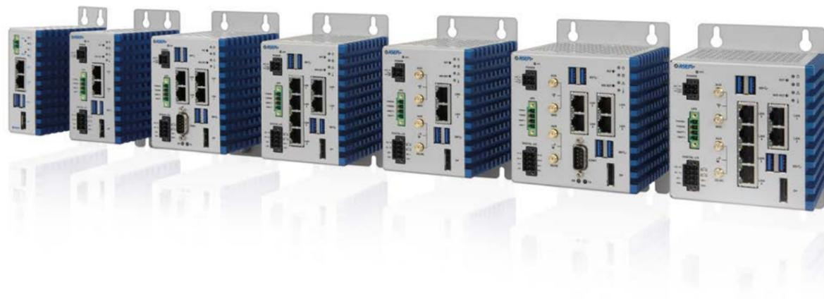
La famiglia Book Mounting fanless IPC BM100, ultra compatti con chassis in alluminio anodizzato per l'installazione a muro o a guida DIN, ideale per applicazioni in spazi ridotti con
