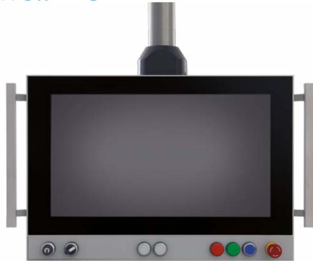
La famiglia di Arm Mounting IPC fanless VK3200 è basata sui processori dual core Celeron e Core™ i3, i5, i7 di quinta generazione della piattaforma Intel® Broadwell™ U. È caratterizzata da chassis Full IP65 in fusione di alluminio, verniciati a polvere con trattamento antigraffio, compatibili con gli standard di installazione più diffusi. L'area pulsanti anteriore è disponibile versione Hard-
