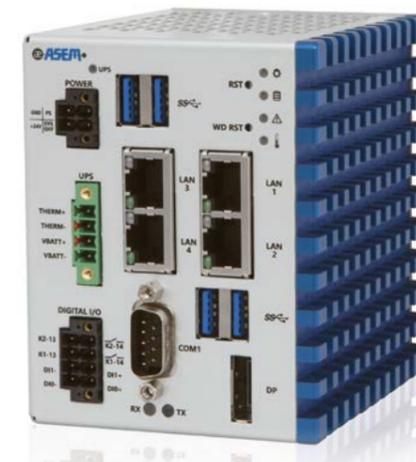
I sistemi fanless BM120, BM121 e BM122 sono dei sistemi compatti basati sui processori Intel® Atom™ x5-3930 1.3GHz (1.8GHz Burst) e x7-E3950 1.6GHz (2.0GHz Burst) a 64bit della piattaforma System On Chip (SoC) Intel® Apollo Lake™. I sistemi sono caratterizzati da un compatto chassis in alluminio (100x100x78mm), che prevede le modalità di installazione book mounting
