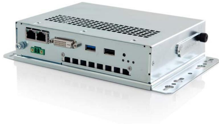
La famiglia di Box IPC fanless entry-level PB2150 offre un ottimo rapporto prezzo/prestazioni ed è basata sul processore a basso consumo Celeron J1900 quad core 2GHz a 64 bit della piattaforma System On Chip (SoC) Intel® Bay Trail™. La motherboard "all in one" include due porte Ethernet 10/100/1000Mbps con
