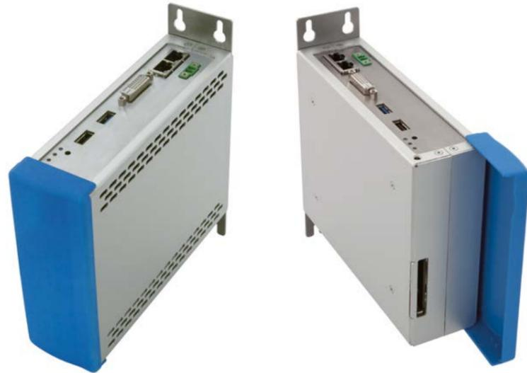
Il Book Mounting IPC fanless entry-level BM2150 offre un ottimo rapporto prezzo/prestazioni ed è basato sul processore a basso consumo Celeron J1900 quad core 2GHz a 64 bit della piattaforma System On Chip (SoC) Intel® Bay Trail™. La motherboard "all in one" include, con accesso
