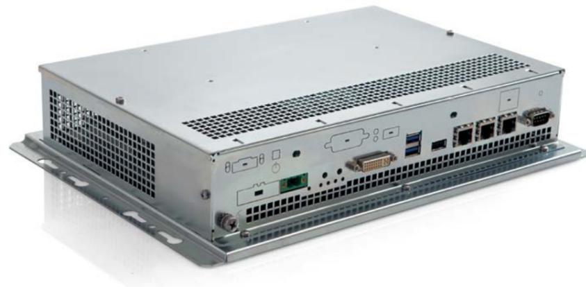
La famiglia di Box IPC fanless PB3200 è basata sui processori dual core Celeron e Core™ i3, i5, i7 di quinta generazione della piattaforma Intel® Broadwell™ U. La motherboard "all in one" include tre porte Ethernet 10/100/1000Mbps con supporto alle funzionalità
