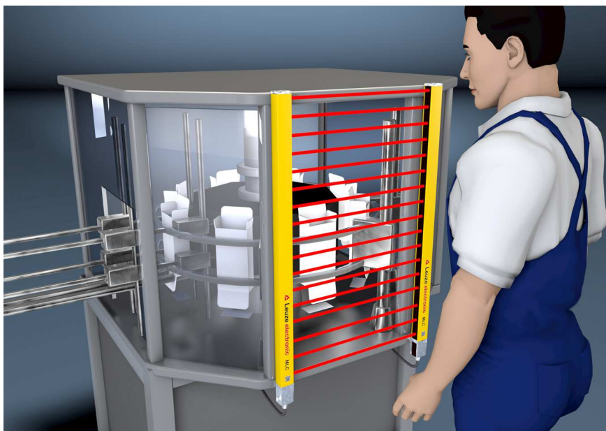
Figura 5.1: Le protezioni di punti pericolosi proteggono durante gli interventi nell'area pericolosa, ad es. presso un'incartonatrice o impianti di imbottigliamento
