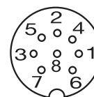
Fig. 4-2 : Affectation des broches du BKS Connecteur du BTL
